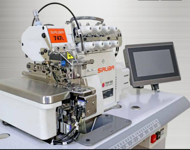
车缝完成时,线头瞬间自动吹回,效率极高, 为一般手动包线头的3倍 以上。
